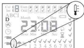
**Boden-/Feuchte Sensor:** optionaler Sensor, bei feuchtem Boden werden die Ventile automatisch geschlossen.
